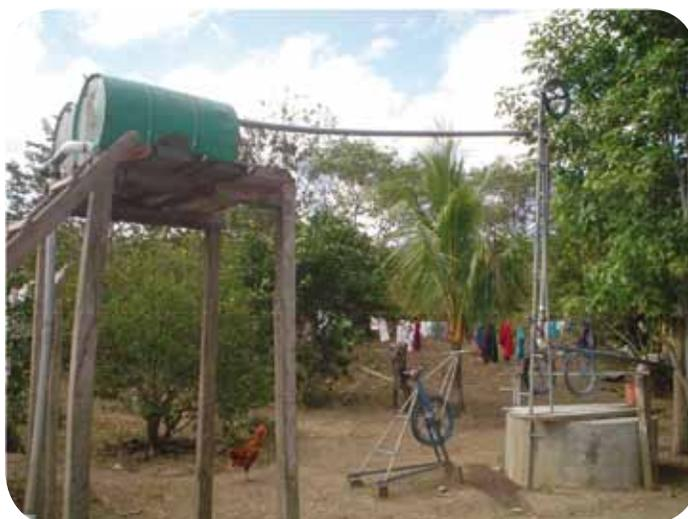
Foto20. Bici-bomba de mecate
