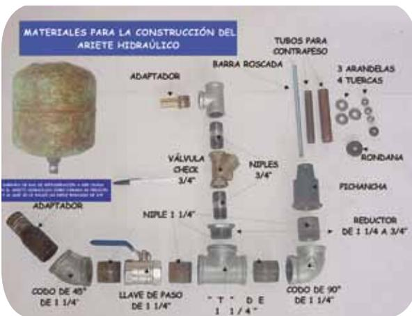
Foto 15 : Materiales para construir bomba de ariete hidráulico
