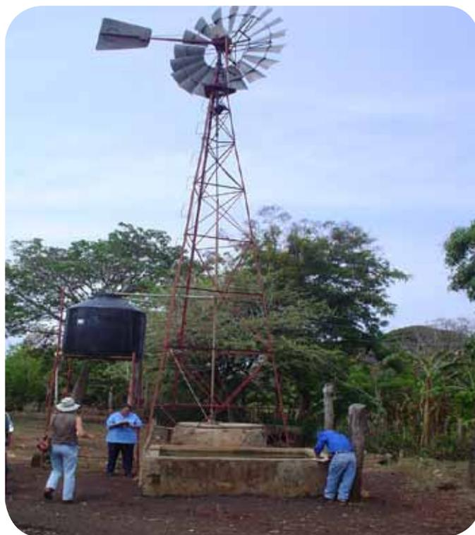
Foto18. Aerobomba de mecate
