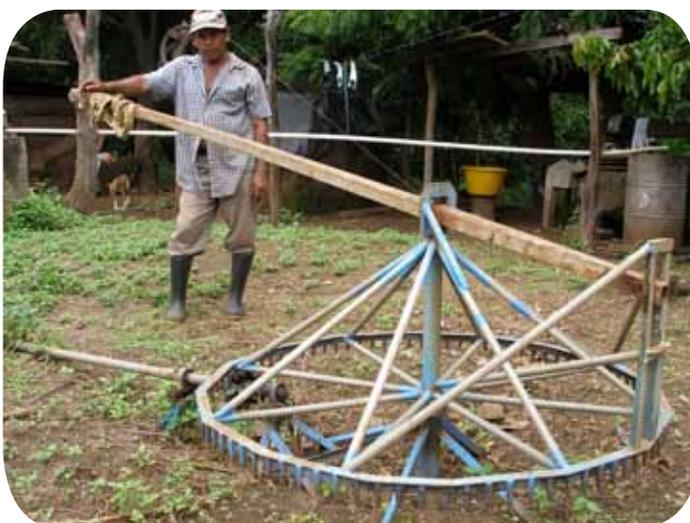
Foto 19. Bomba de mecate con tracción animal
